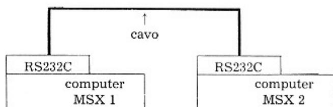
Per chiarezza: nel nostro esempio un computer MSX comunica con un altro computer MSX, ma in generale l'altro computer potrebbe anche essere un qualsiasi altro dispositivo dotato di una interfaccia RS232C (pensate per esempio a un modem che comunica via telefono con un altro computer).
